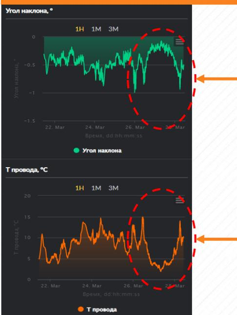
Высокое натяжение провода при низких температурах
